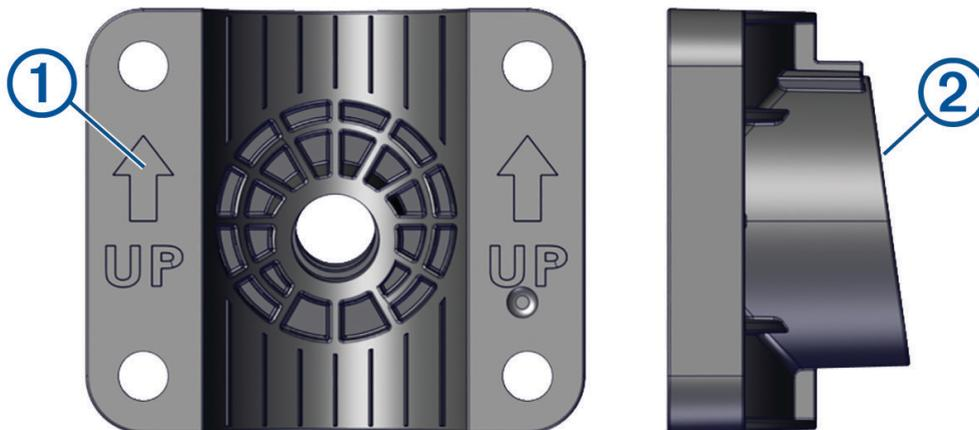
**HINWEIS:** Die im Lieferumfang enthaltene Schafthalterung weist einen Winkel von 8 Grad auf, um die Auswirkungen der Störungen durch die Welle des Elektromotors auf den Kegel des Gebers zu reduzieren.
