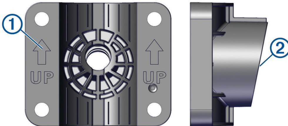
**HINWEIS:** Die Halterung für den Perspektivenmodus hat einen Winkel von 11 Grad, damit der Verlängerungsarm zwischen allen drei Echolotansichten wechseln kann.
