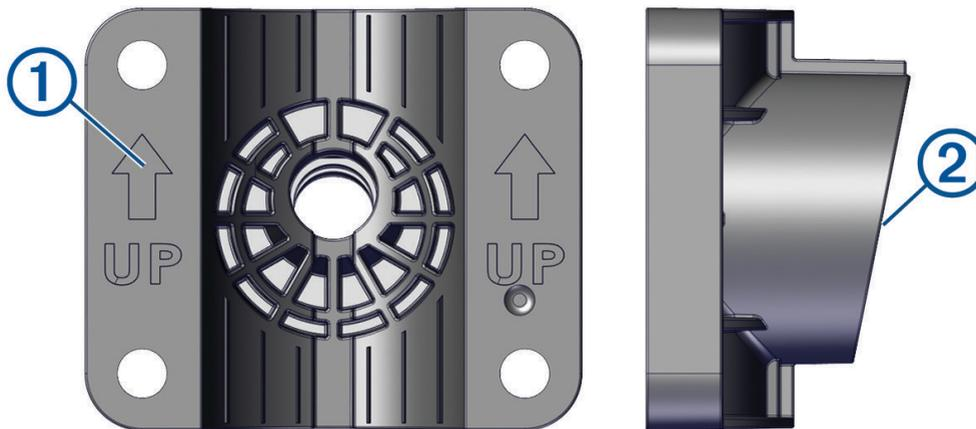
**NOTA:** el conjunto del soporte con perspectiva tiene un ángulo de 11 grados para permitir que el brazo de extensión cambie entre las tres vistas de sonda.
