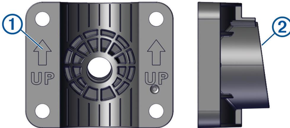
**NOTA:** el soporte para eje del motor eléctrico de arrastre tiene un ángulo de 8 grados para reducir los efectos de la interferencia del tambor del motor eléctrico de arrastre con el haz del transductor.
