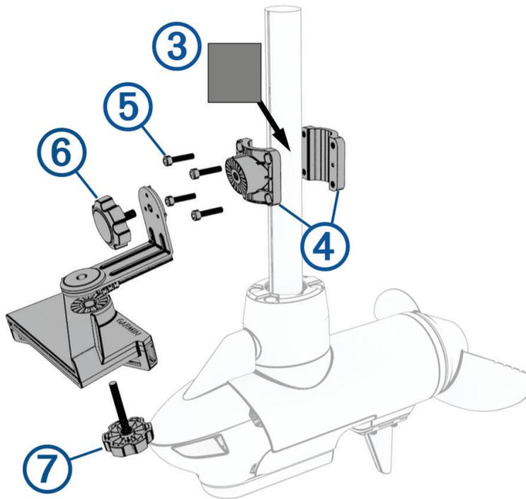
**NOTA:** el revestimiento de goma no es necesario al instalar el transductor en un motor eléctrico de arrastre con un eje de más de 25 mm (1 in) de diámetro.
