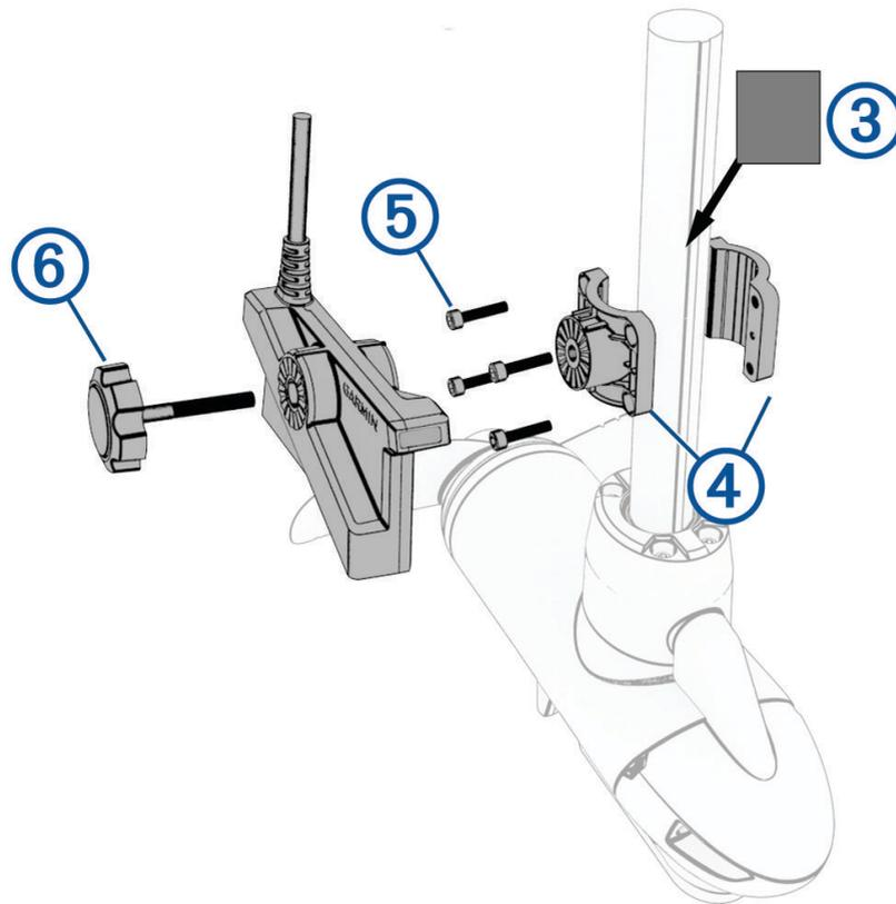
**REMARQUE** : la garniture en caoutchouc n'est pas nécessaire lors de l'installation de la sonde sur un moteur électrique dont le diamètre de l'arbre est supérieur à 25 mm (1 po).
