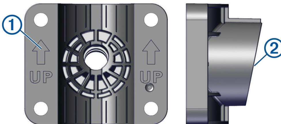
**REMARQUE** : le support en mode perspective présente un angle de 11 degrés pour permettre au bras d'extension de basculer entre les trois vues du sondeur.
