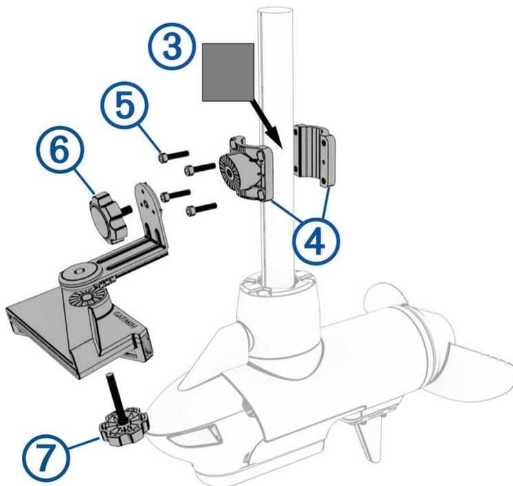
**OBSERVAÇÃO:** o revestimento de borracha não é necessário ao instalar o transdutor em um motor elétrico com um diâmetro de eixo maior que 25 mm (1 pol.).
