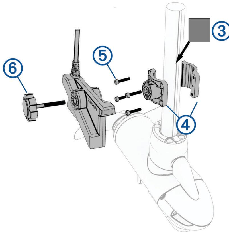
**OBSERVAÇÃO:** o revestimento de borracha não é necessário ao instalar o transdutor em um motor elétrico com um diâmetro de eixo maior que 25 mm (1 pol.).
