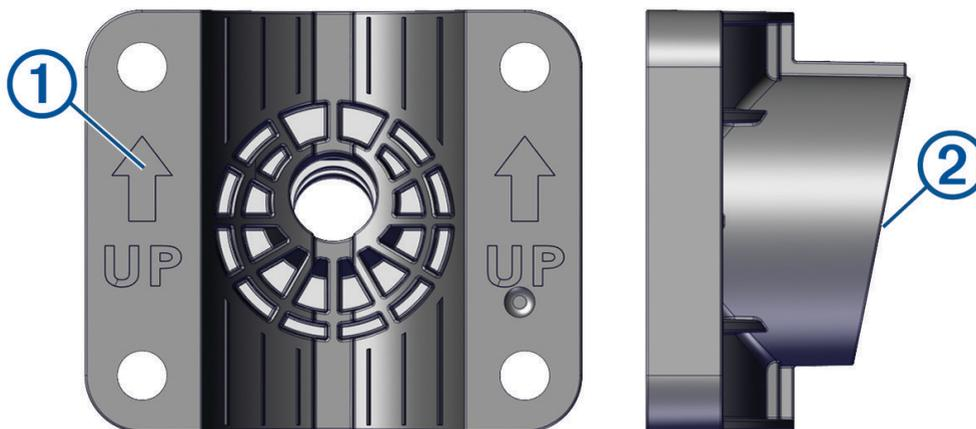
**OBSERVAÇÃO:** o suporte do modo de perspectiva tem um ângulo de 11 graus para permitir que o braço de extensão faça a transição entre as três visualizações do sonar.
