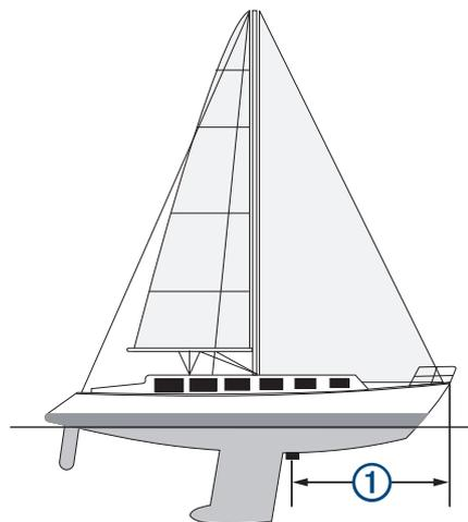
**2** Na visualização de um sonar, selecione **MENU > Configuração do sonar > Instalação > Deslocamento da proa**.
