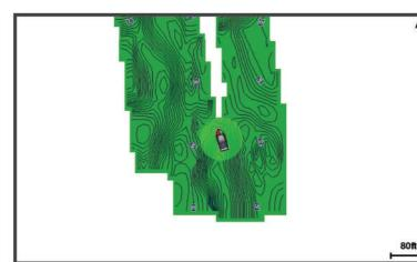
Un cercle vert indique que la profondeur et la position GPS sont bonnes et que la vitesse est inférieure à 16 km/h (10 mph). Un cercle jaune indique que la profondeur et la position GPS sont bonnes et que la vitesse se situe entre 16 et 32 km/h (entre 10 et 20 mph). Un cercle rouge indique que la profondeur et la position GPS sont mauvaises et que la vitesse est supérieure à 32 km/h (20 mph).
