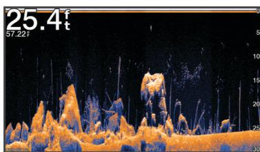
Les sondes classiques émettent un faisceau conique. La technologie du sondeur à balayage Garmin ClearVü émet deux faisceaux étroits dont la forme ressemble au faisceau d'une photocopieuse. Ces faisceaux permettent d'obtenir une image plus claire de l'environnement sous le bateau.
