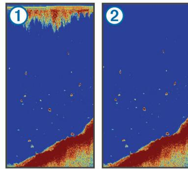
Le bruit de surface ① est causé par une interférence entre la sonde et l'eau. Vous pouvez masquer le bruit de surface ② pour atténuer les parasites. Les largeurs de faisceau plus importantes (fréquences plus basses) peuvent afficher plus de cibles mais générer plus de bruit de surface.
