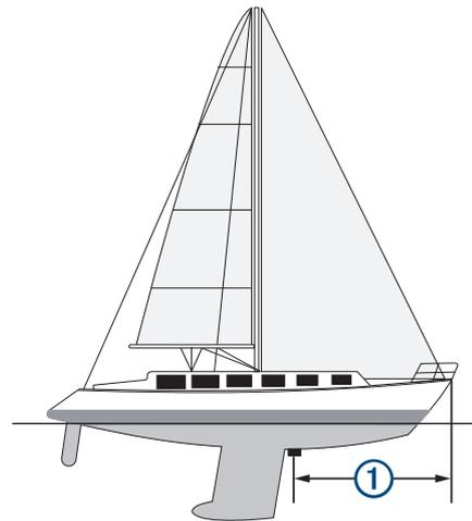
2 Wählen Sie in einer entsprechenden Echolotansicht die Option **MENU > Echoloteinstellungen > Installation > Bugversatz**.
