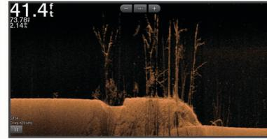
Traditionelle Geber senden einen konischen Kegel. Die Garmin ClearVü Scanning Echolottechnologie sendet zwei schmale Kegel, die dem Strahl in einem Kopiergerät ähneln. Diese Kegel produzieren ein klares, realitätsnahes Bild der Ansicht unter dem Schiff.
